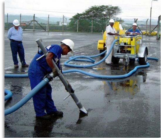
Aspirar el agua de las actividades de lavado a presión es una manera efectiva de evitar que las aguas residuales entren al sistema de drenaje de lluvia.
